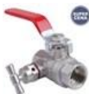
Ventil kulový s páčkou plnopřítokový ventily snesou teplotu 0°C - +95°C a tlak od 0 do 1,6 MPa...
