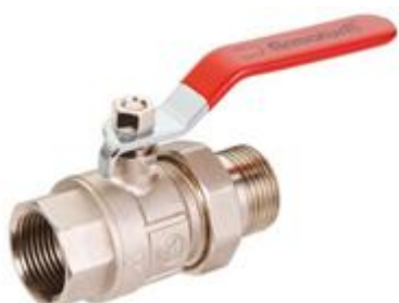
Ventil kulový s páčkou plnopřítokový ventily snesou teplotu 0°C - +95°C a tlak od 0 do 1,6 MPa...
